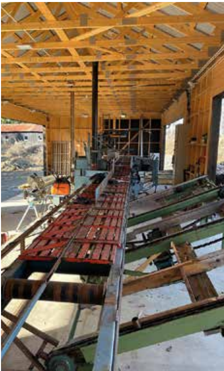
Den nye einmannsbetjente Laimet 120-saga er montert og vil effektivisere og auke fleksibiliteten i produksjonen.
